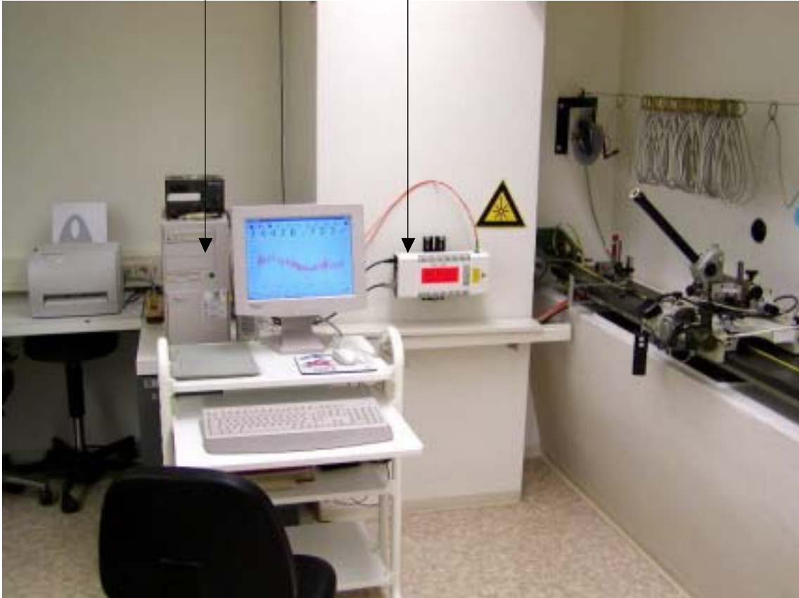
Lasermesskopf ZLM 500 mit zugehöriger Messkarte im PC
