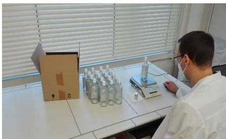
Anhand von Stichproben und unter Verwendung präziser Messgeräte sowie entsprechender Prüfsoftware wird geprüft, ob die durchschnittliche Füllmenge (Mittelwert) einer Stichprobe der angegebenen Nennfüllmenge entspricht und die von der Nennfüllmenge abhängigen zulässigen Toleranzen (zulässige Minusabweichung, Wert der Verkehrsfähigkeit) eingehalten werden (§ 9 FPackV).
